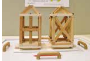
市内の公共建物には、筋交い*が施された耐震建物が多く見られる
